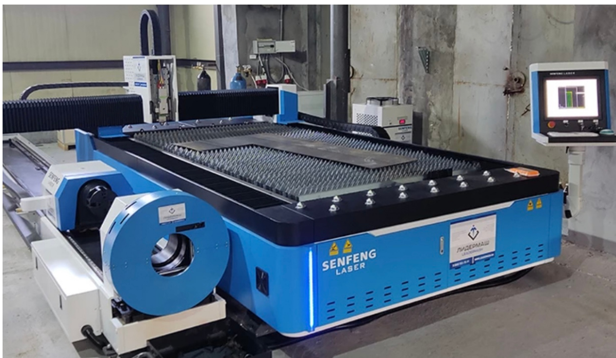
Производство листового перфоизделия на станке SENFENG SF3015G.
