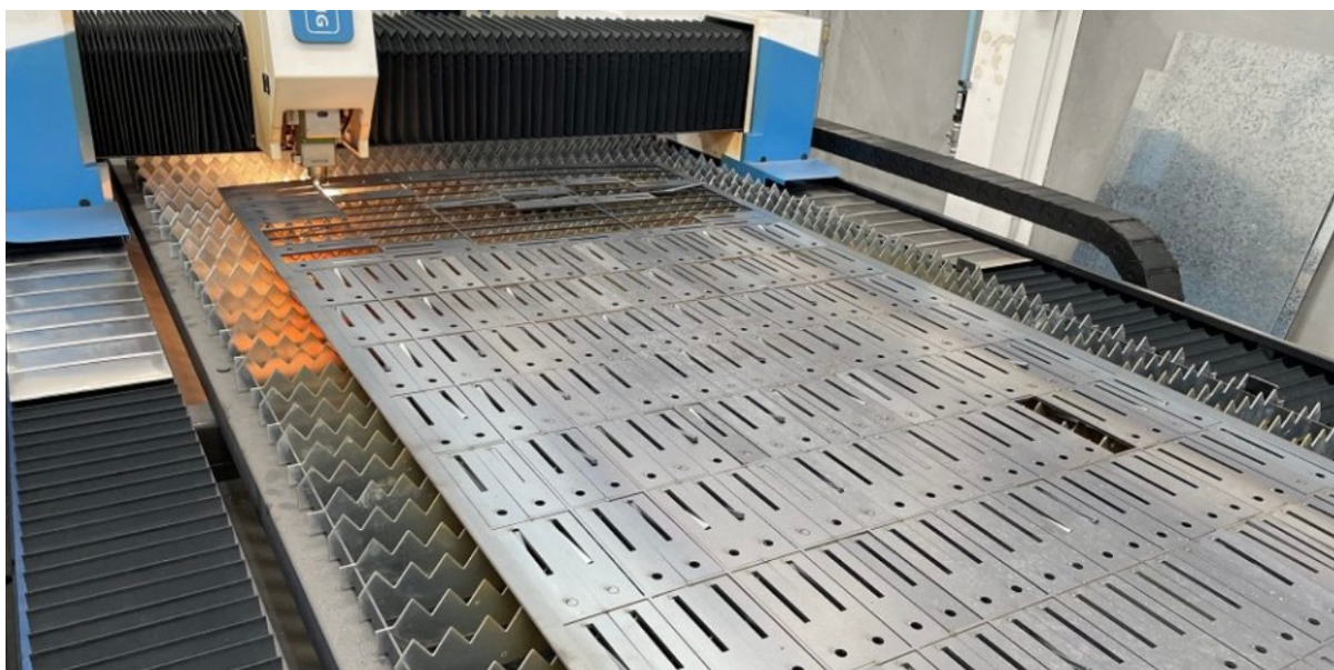
Перфорация листового металла на станке SENFENG SF3015G по чертежам Заказчика.
