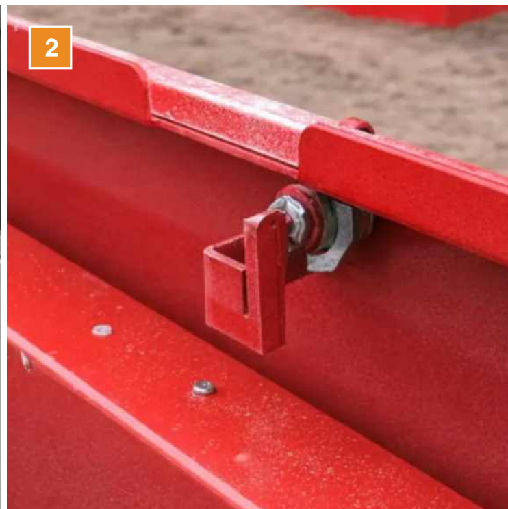
2. Запорный механизм замка с внутренней стороны корпуса люка
